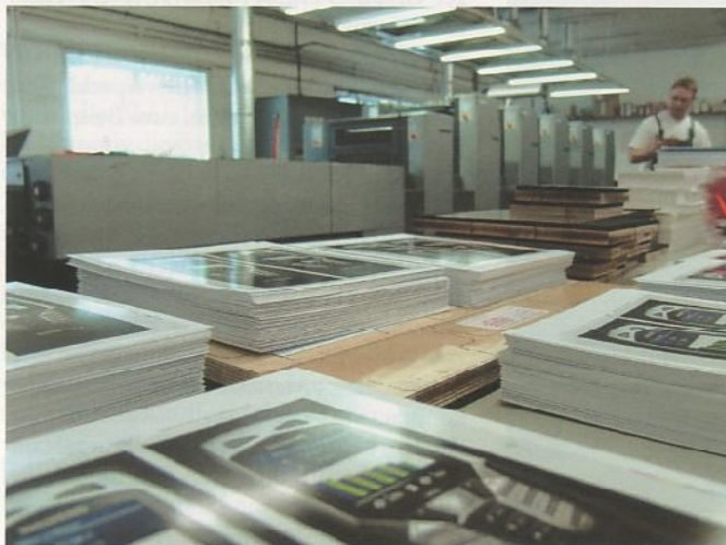
Das Herz des Drucksaals bei Klenke Druck: Die Heidelberg Speedmaster SM 52-5 mit Lackwerk und UV-Ausstattung.
